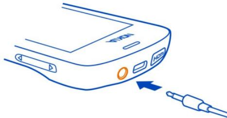
Не подключайте аппаратуру, которая формирует выходной сигнал, поскольку в результате устройство может оказаться повреждено. Не подключайте источники напряжения к разъему Nokia AV. При подключении к разъему Nokia AV внешнего устройства или минигарнитуры, отличных от рекомендованных корпорацией Nokia для данного устройства, уделите особое внимание уровню громкости.
