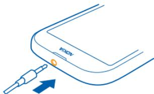
Не подключайте аппаратуру, которая формирует выходной сигнал, поскольку в результате устройство может оказаться повреждено. Не подключайте источники напряжения к звуковому разъему. При подключении к звуковому разъему Nokia внешнего устройства или минигарнитур, отличных от рекомендованных корпорацией Nokia для данного устройства, обратите внимание на уровень громкости.
