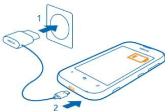
2. После полной зарядки аккумулятора отключите зарядное устройство от телефона, а затем от сетевой розетки.
