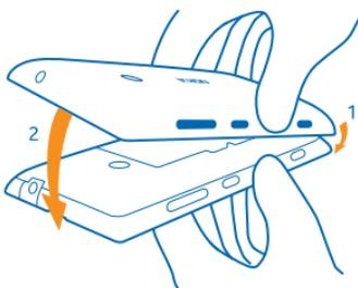
6. Нажмите на заднюю панель, чтобы она зафиксировалась. Не нажимайте на клавиши при установке панели.
