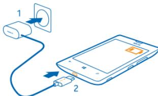
2. После полной зарядки аккумулятора отключите зарядное устройство от телефона, а затем от сетевой розетки.
