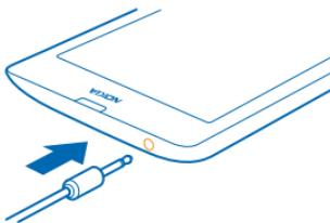
Не подключайте аппаратуру, которая формирует выходной сигнал, поскольку в результате устройство может оказаться повреждено. Не подключайте источники напряжения к звуковому разъему. При подключении к аудиоразъему внешнего устройства или мини-гарнитуры, отличных от рекомендованных для данного устройства, уделите особое внимание уровню громкости.
