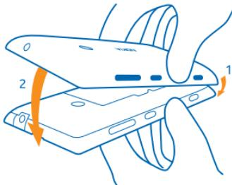
6. Нажмите на заднюю панель, чтобы она зафиксировалась. Не нажимайте на клавиши при установке панели.
