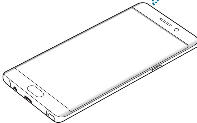
1 Вставьте штифт для извлечения в отверстие слота, чтобы ослабить его.
